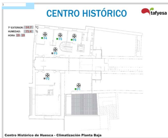
Ilustración 9: Sistema de gestión producción de frío. Ctos secundarios PB y P1
